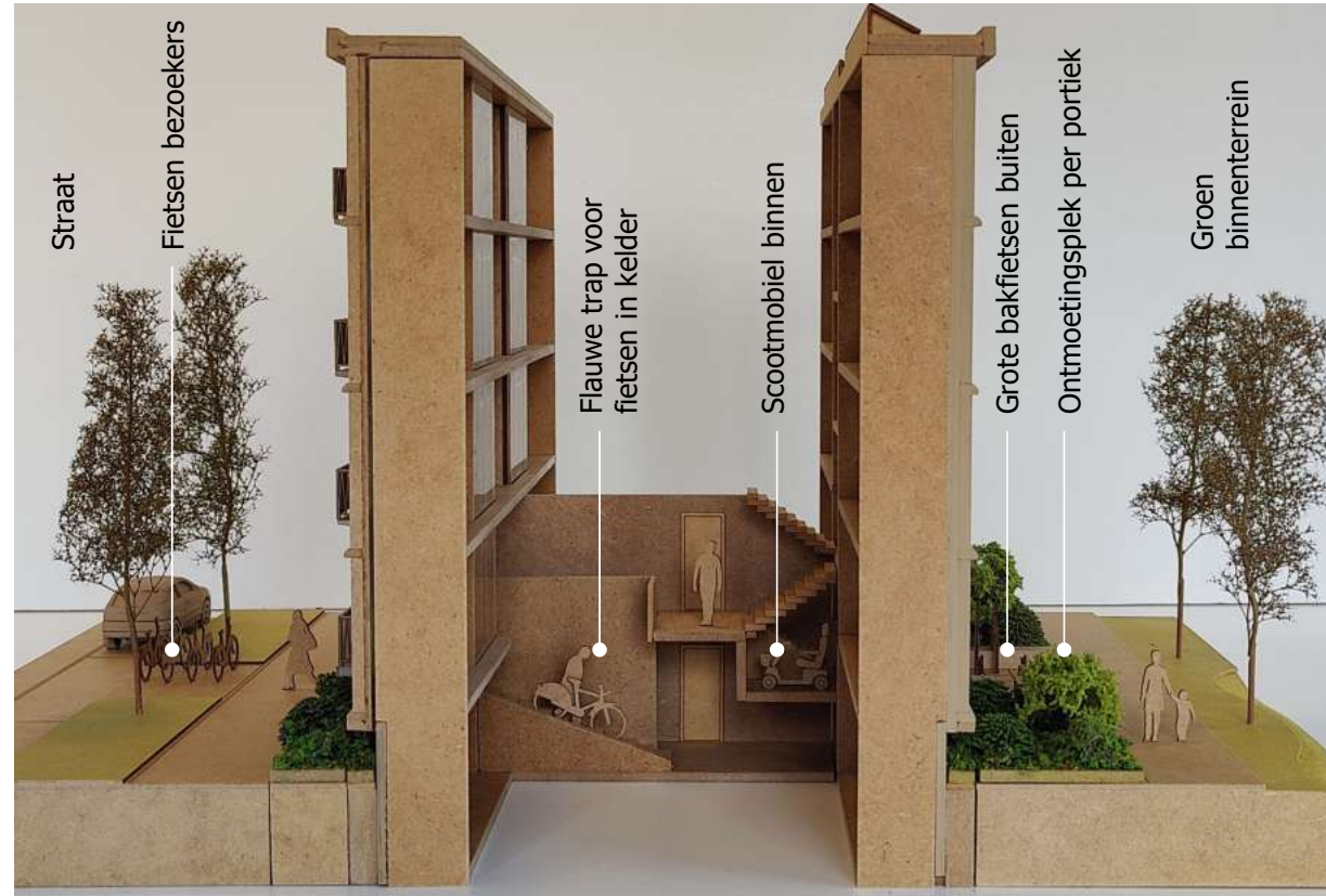
Oplossing bereikbaarheid kelderlaag portiek
